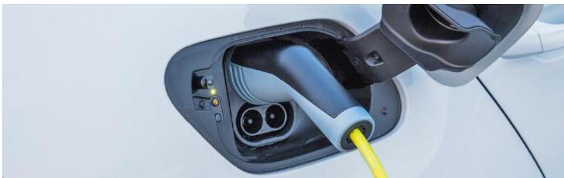
La elección de los conectores depende del tipo de cargador (toma) y del puerto de entrada del vehículo. En el lado del cargador, los cargadores rápidos utilizan CHAdeMO, CCS (Estándar de carga combinada) o conectores de tipo 2.
