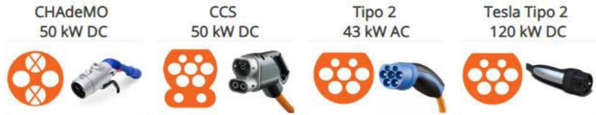
Los modelos EV que utilizan la carga rápida CHAdeMO incluyen el Nissan Leaf, el Mitsubishi Outlander PHEV y el Kia Soul EV. Los modelos compatibles con CCS incluyen el BMW i3, VW e-Golf y Hyundai Ioniq Electric. El Modelo S y el Modelo X de Tesla pueden utilizar exclusivamente la red Supercharger, mientras que el único modelo que actualmente se puede cargar en Rapid AC es el Renault Zoe.
