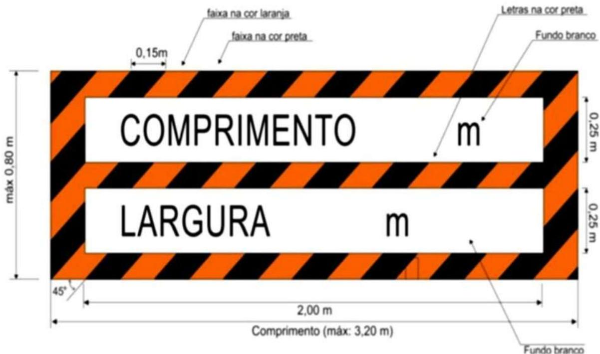
Figura 6: Sinalização especial de advertência traseira para comprimento e largura excedente
